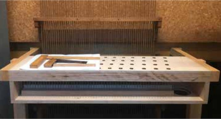
Zusatzlade im Bauzustand: Innerhalb der Lade wird der Orgelwind durch versteckte Kanäle zur richtigen Pfeife gelenkt. Auf den Löchern stehen später die Pfeifen.
